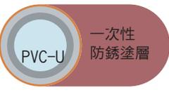
一次性防銹塗層  | 外表面：棕色<br>內表面：灰色   | 配管用碳塑鋼管<br>JIS G 3452(黑) | 一次性防銹塗層 | PVC-U 管 | 室內冷水用管道      |
