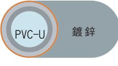
鍍鋅       | 外表面：銀白色<br>內表面：灰色  | 配管用碳塑鋼管<br>JIS G 3442    | 鍍鋅      |         | 室內和室外冷水用管道   |
