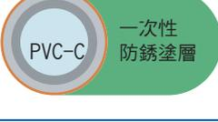
一次性防銹塗層 | 外表面：墨綠色<br>內表面：咖啡色 | 配管用碳塑鋼管<br>JIS G 3452(黑) | 一次性防銹塗層 | PVC-C 管 | 室內熱水用管道      |
